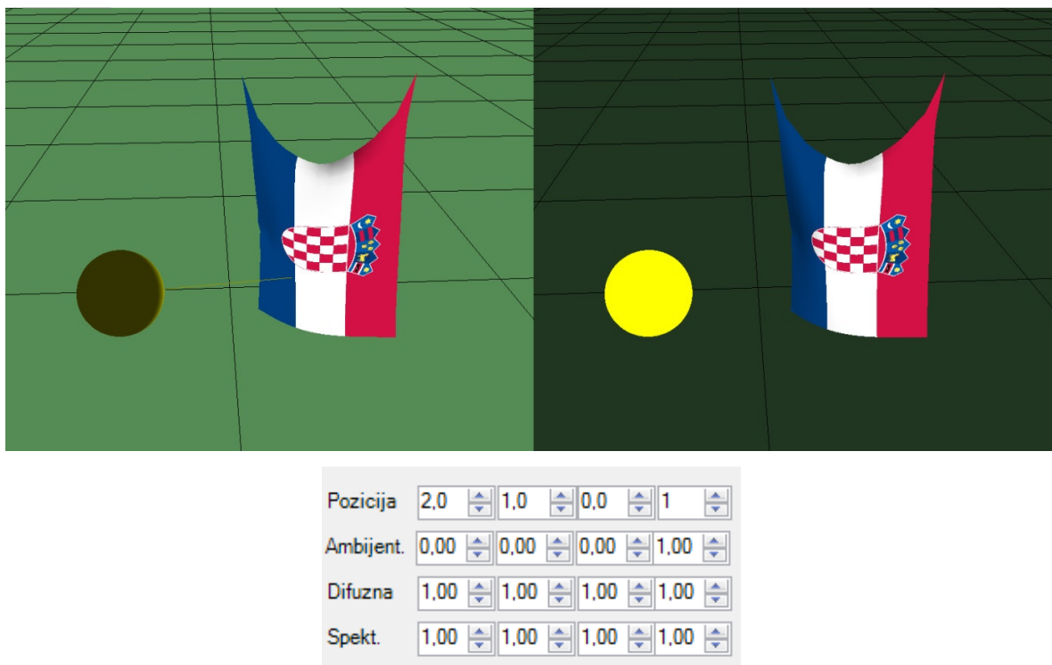
Slika 4.1 Prikaz objekta sunca, usmjerenog i radijalnog djelovanja te parametara koji ga opisuju.
